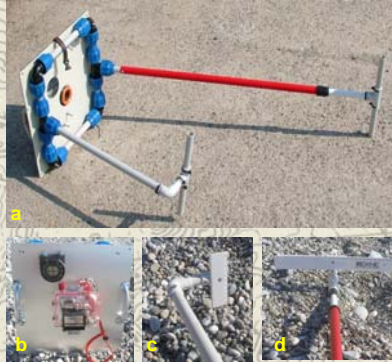
Fig. 1 - a) distanziale metrico con bracci, b) base portante con bussola e apparecchio fotografico, c) riferimento metrico di 10 cm (braccio di 50 cm), d) riferimento metrico di 30 cm (braccio 1 m)
