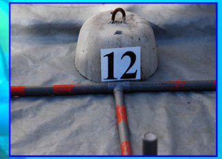
Fig.1 - Corpo morto in cemento (balise)
