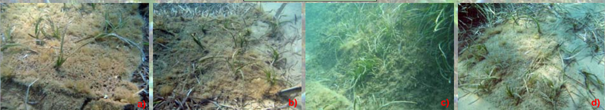
Fig. 3 - a) materasso tipo "Reno" dopo 7 mesi, b) coperchio "Macmat R" su sabbia dopo 7 mesi, c) coperchio "Macmat R" su matto dopo 7 mesi, d) biostuoia in fibra di agave dopo 7 mesi
